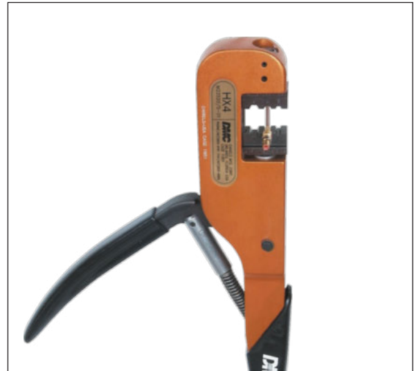
Crimping the outer conductor with hand crimp tool M22520/5-01. Crimpfung des Außenleiters mit der Handcrimpzange M22520/5-01.
