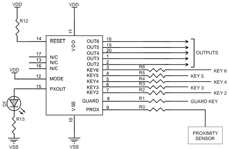
**Figure 1-3.** 20-pin VQFN – Comms Mode
